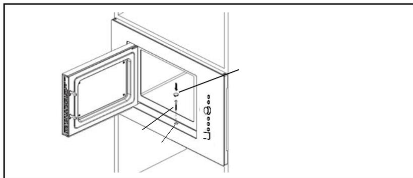
2. 開啟爐門，使用螺絲將微波爐固定至櫥櫃，並將其固定在飾邊套件的安裝孔上。之後，將飾邊套件的塑膠蓋固定至安裝孔。
